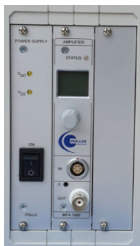
Gehäuse für ein, zwei oder mehr Verstärker inkl. zentraler Spannungsversorgung
